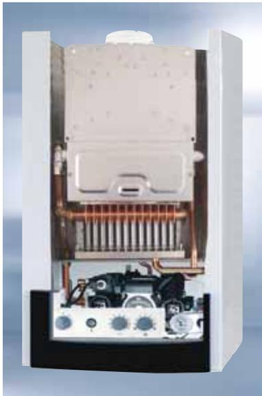
Raumluftabhängige Gas-Heizwertkombitherme für Niedertemperaturheizung und Warmwasserbereitung mit integriertem Warmwasserwärmetauscher, elektronischer Abgasüberwachung, geprüft nach EG-Richtlinien für den Anschluss an Schornstein
