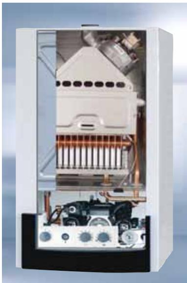
Raumluftunabhängige Gas-Heizwerttherme für Niedertemperaturheizung mit Anschlussmöglichkeit eines Speicher-Wassererwärmers z.B. CSW-120, elektronischer Rohrlängen-Anpassung „ERA“, Ventilator stufenlos drehzahl geregelt, geprüft nach EG-Richtlinien für den Anschluss an Luft-/Abgasschornstein oder Luft-/Abgasführung ins Freie
