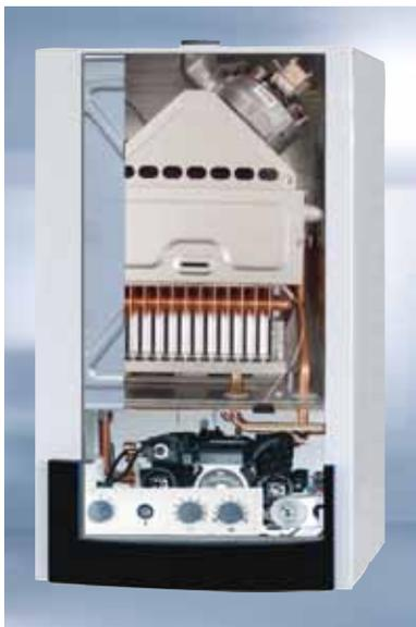
Raumluftunabhängige Gas-Heizwertkombitherme für Niedertemperaturheizung und Warmwasserbereitung mit integriertem Warmwasserwärmetauscher, elektronischer Rohrlängen-Anpassung „ERA“, Ventilator stufenlos drehzahl geregelt, geprüft nach EG-Richtlinien für den Anschluss an Luft-/Abgasschornstein oder Luft-/Abgasführung ins Freie
