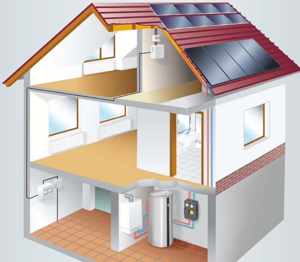
In Deutschland entwickelt sich die Kombination von modernen Heizkesseln und solarthermischen Anlagen zum Standard. Allein 2008 sind im Neubau und in der Modernisierung 210 000 Anlagen hinzugekommen. Mehr als die Hälfte dieser Anlagen sind als solare Heizungsunterstützung ausgeführt worden, sie unterstützen also als Kombianlagen neben der Trinkwassererwärmung auch die Raumheizung.
