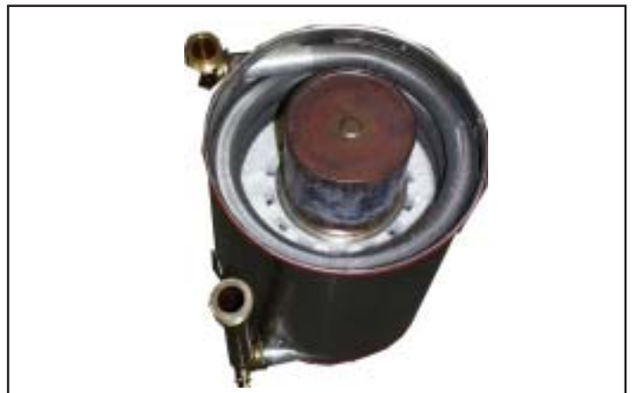
Bild: Isolierung mit Brenner herausdrücken
