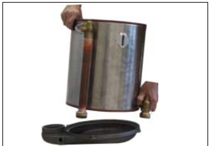
Bild: Wärmetauscher nach oben abnehmen
