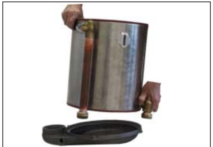
Fig: Tirar del intercambiador hacia arriba
