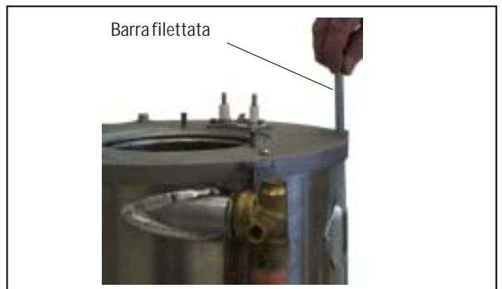
Fig.: Barra filettata coperchio camera di combustione
