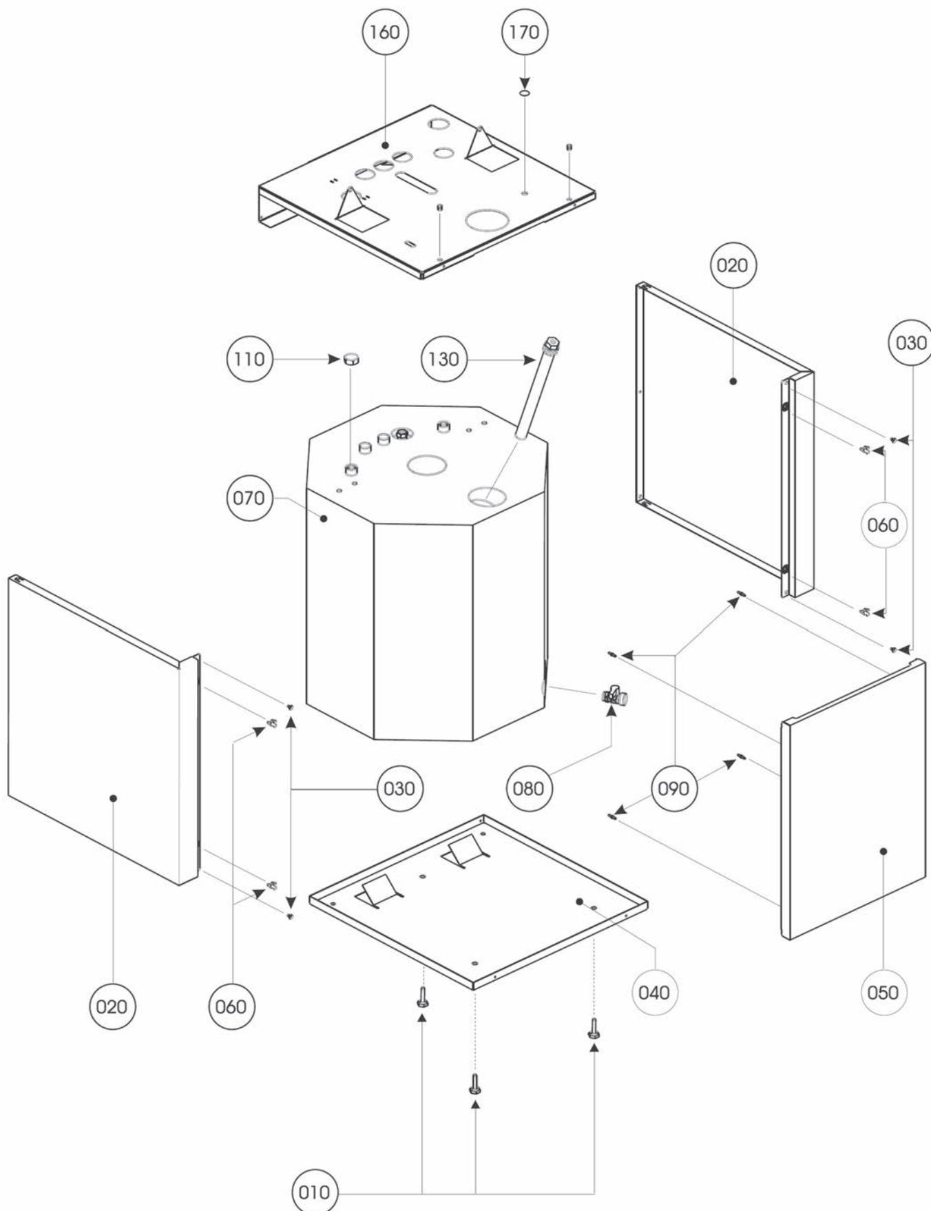
**Gasbrennwert-Zentrale stehend mit emailli. Schichtensp.**
