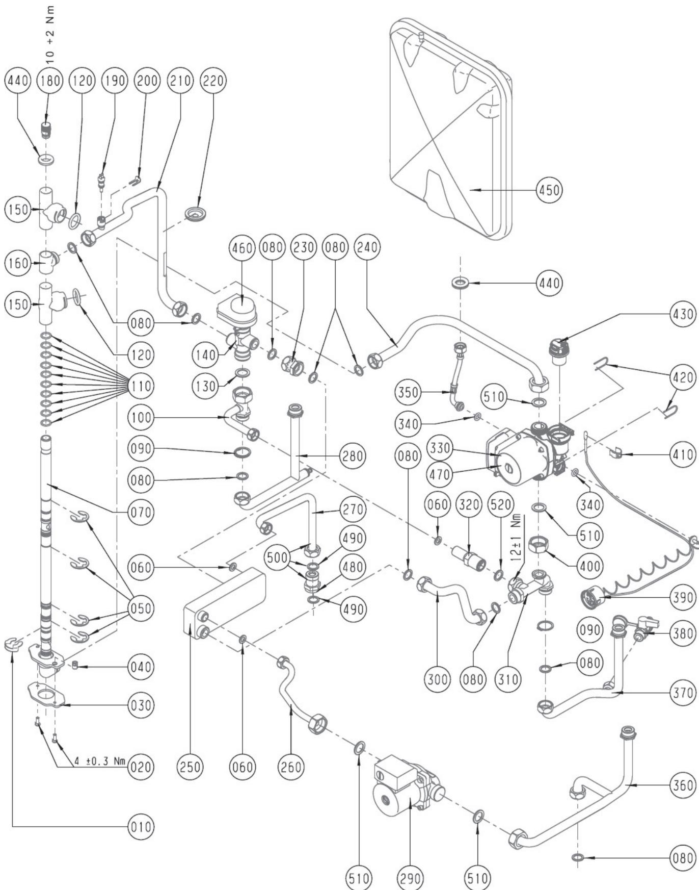
**Gasbrennwert-Zentrale stehend mit emailli. Schichtensp.**
