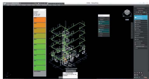
2-D-/3-D-Rohrnetzberechnung mit Visualisierung verschiedener Betriebszustände
