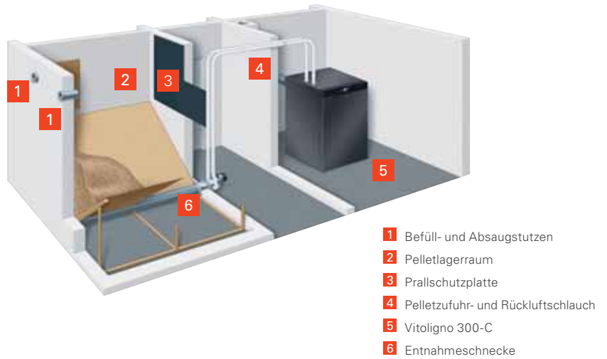
Einbaubeispiel Lagerraum mit Zuführung zum Pelletkessel durch Vakuum-Saugsystem
