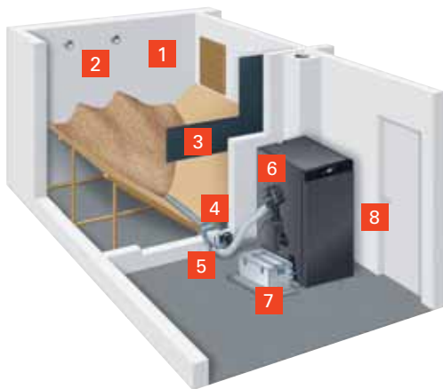
Lagerraum mit Zuführung zum Pelletkessel durch flexible Schnecke
