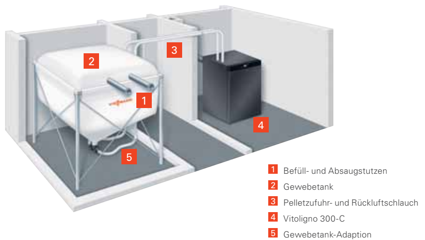
Pelletsilo (Gewebetank) mit Zuführung zum Pelletkessel durch Vakuum-Saugsystem
